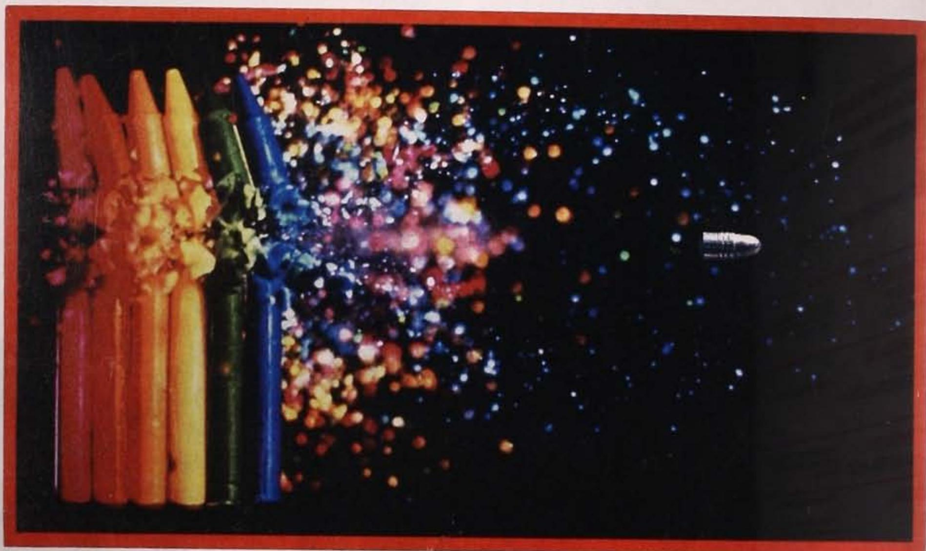
Tecnología de alta precisión: El disparo a los crayones fue hecho con una bala calibre 22 que viajaba a una velocidad de 304.8 m/seg. Para tomar la foto se utilizó un microflash estroboscópico a 1/3 de microsegundo. Foto de Ron Buccino, laboratorio de Luz Estroboscópica, M.I.T., de Cambridge, Mass., U.S.A.
