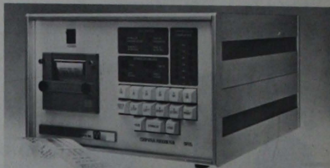
MODELOS MA-26 y MA-28. Audiómetros computador automáticos. Sistema de microproceso. Exámenes rápidos y exactos grabados automáticamente. Modelo MA-26 tiene frecuencias de 500 Hz a 6,000 Hz por vía aérea mientras que el MA-28 tiene una frecuencia más, 500 Hz a 8,000 Hz. Mediante el uso de un accesorio interface los resultados son retenidos en la memoria de un computador central.
