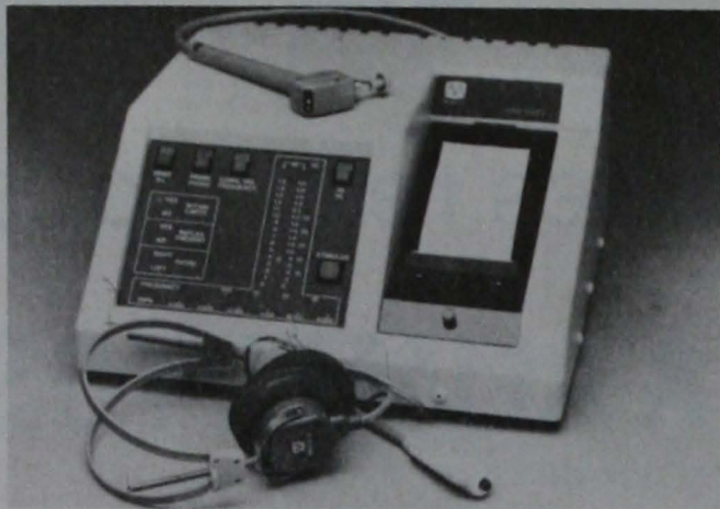
IMPEDANCIOMETRO AUTOMATICO MAICO MODELO 620. Dos instrumentos en una sola unidad compacta. Audiometría e impedanciometría para pruebas del barrido. Presión selectiva y límites de complianza. Prueba del reflejo. Grabación instantánea del timpanograma y reflejo. Cuatro frecuencias a cinco niveles para pruebas audiométricas. La prueba de impedanciometría se hace en menos de 5 segundos.
