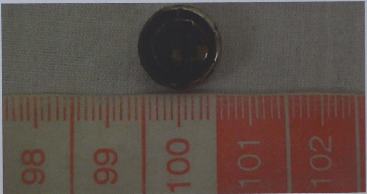
Imagen 3. Batería tipo botón de 10mm de diámetro
